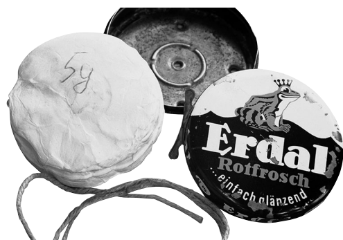
Abbildung 4. Schuhcremedose als Reaktionsbehälter zur Herstellung von Styropor®.
